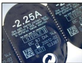
对于上文中提及的大多数常见的医药应用，典型的 30 瓦二氧化碳激光打码机或 20 瓦光纤激光打码机与采用 TIJ 技术的喷码机相比，可提供非常有竞争力的线速度。随着基底变得越来越具有挑战性（例如塑料、金属箔、金属），可能需要延长标记时间并降低运行线速度。但是，这些应用超出了采用 TIJ 技术的应用窗口 – 将激光技术设定为默认技术。喷码和标记专家应协助对上文中详述的多重因素进行应用评估。
